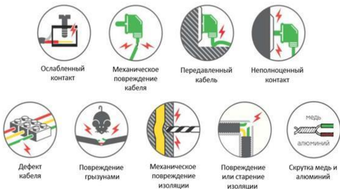
Рисунок 6. Возможные причины искрения в электропроводке
