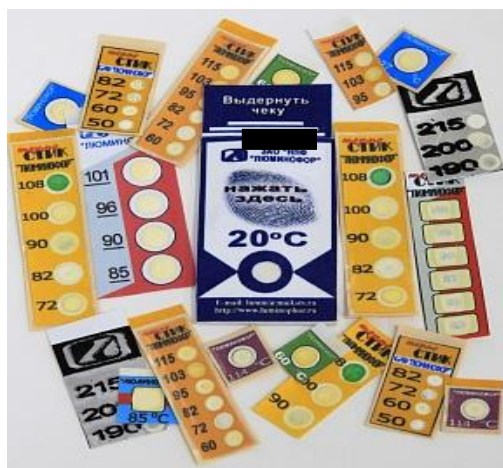
Рисунок 13. Примеры термоиндикаторных наклеек различных производителей
