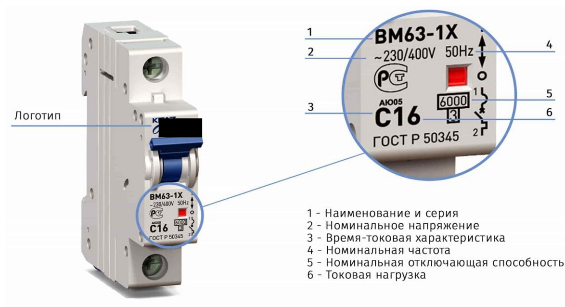
Рисунок 2. Пример маркировки АВ
